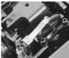
Lamelle à cliquet pour crantage.
